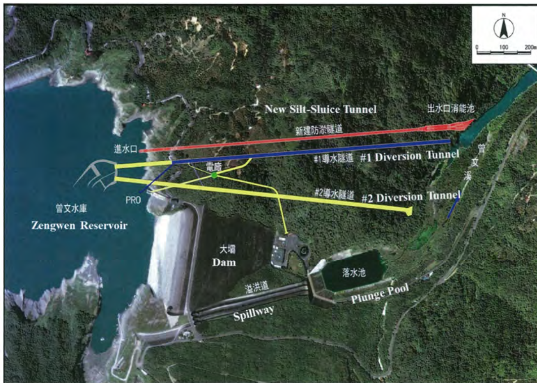
参考-8 曾文ダムの土砂スルーストンネル（運用中）の平面レイアウト 3)
