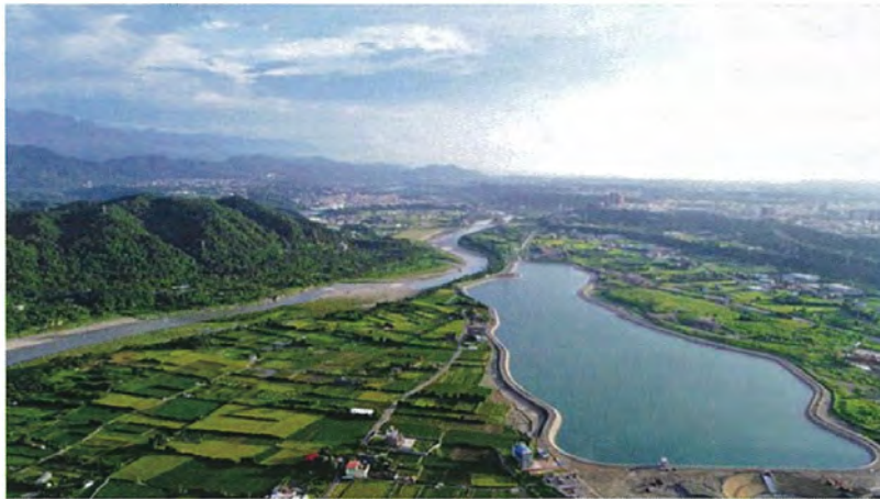
参考-6 石門ダム下流河川に設置された排砂中の取水を行うための遊水池（運用中） 3)
