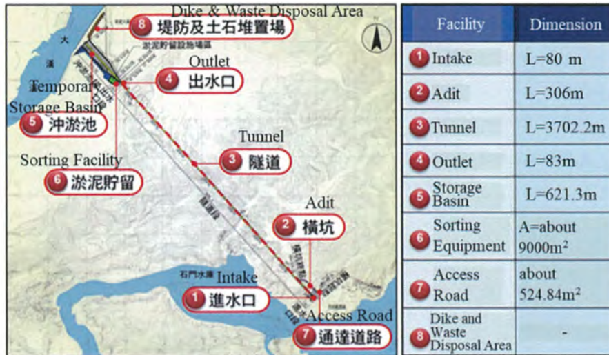
参考-3 石門ダムの Amuping トンネル（建設中）概要 3)
