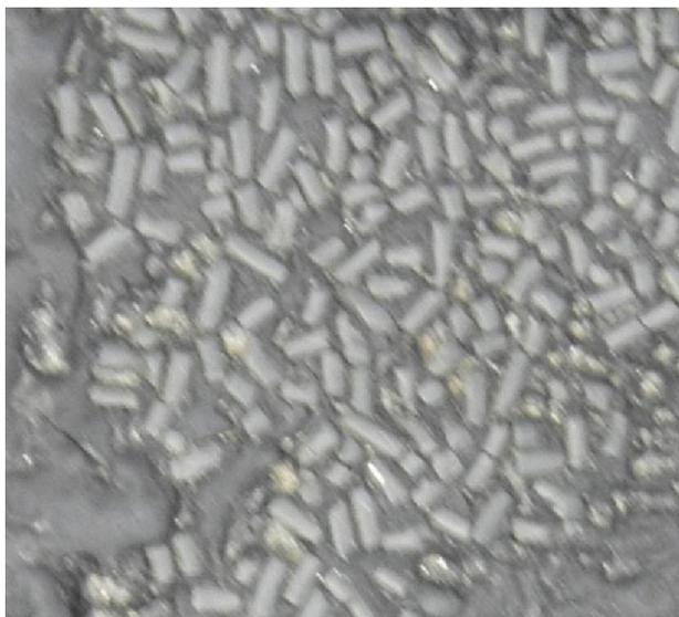
写真 3-2 セラミックチップの練入状況
