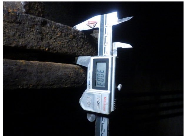
写真-5 フランジ厚さ測定（機器校正用）
