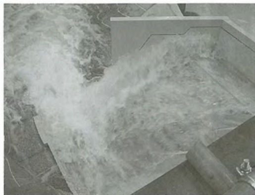
図-6 水理模型実験での流況 (導流部: 原案形状)
