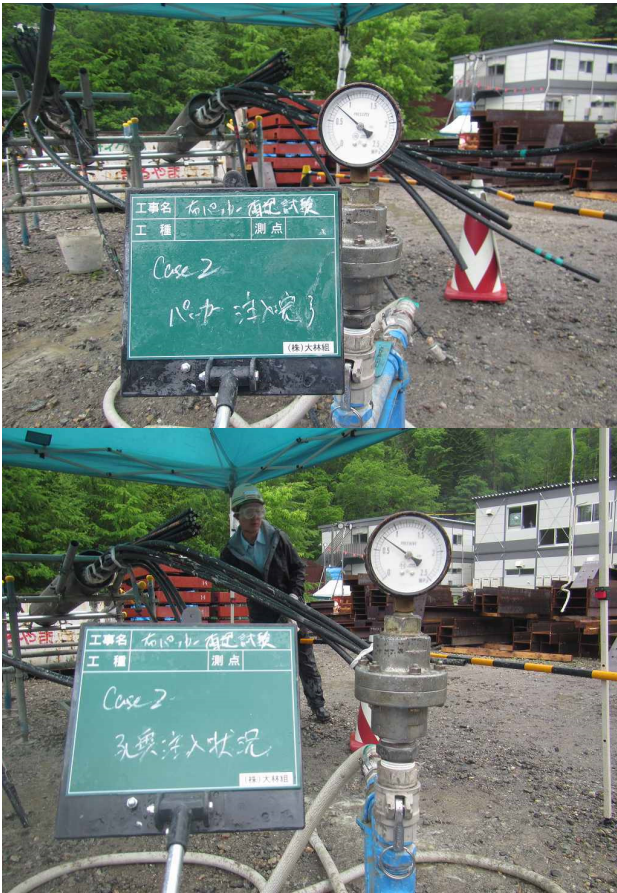
写真-3 Case7 注水試験状況：最終注水圧は口元で0.5MPa以上とした。
