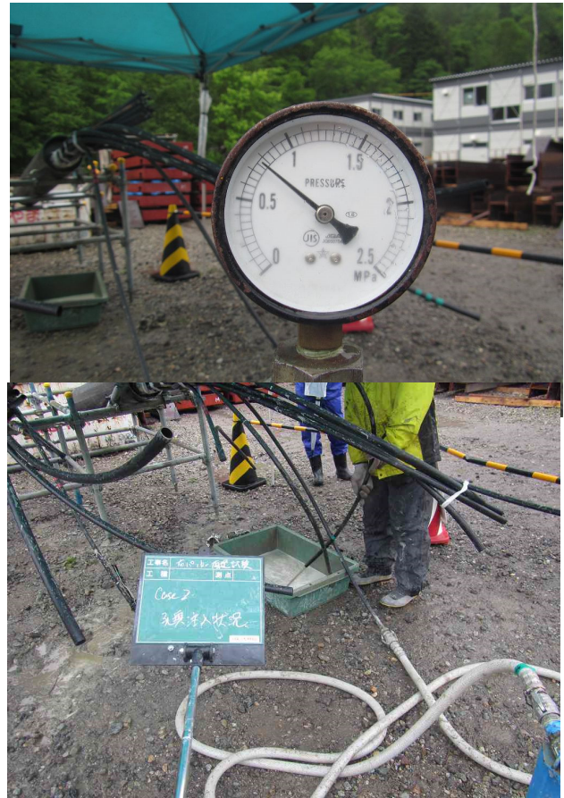
写真-3 Case7 注水試験状況：最終注水圧は口元で0.5MPa以上とした。
