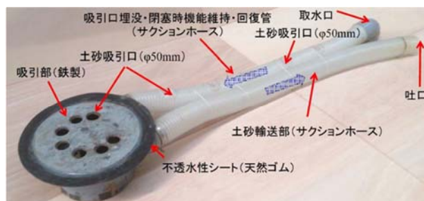
φ100mm 潜行吸引式排砂管
