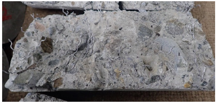
図8 補修に用いた鋼繊維サンプル (左) と清水沢ダムSFRCの圧縮試験後の供試体 (右)
