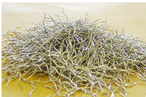
図8 補修に用いた鋼繊維サンプル (左) と清水沢ダムSFRCの圧縮試験後の供試体 (右)
