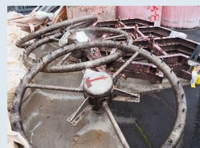
▲暫定運用された際の散気管。直径約1.5mの円形の管に穴が空けられている
